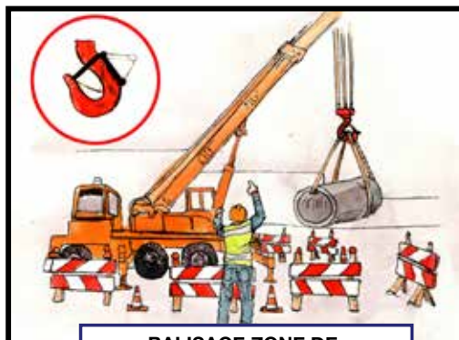
BALISAGE ZONE DE MANŒUVRE DE LA GRUE
