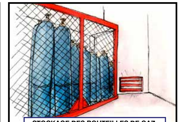
STOCKAGE DES BOUTEILLES DE GAZ
